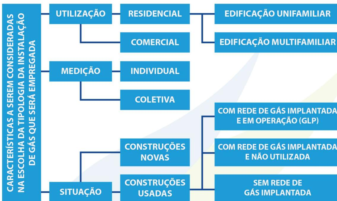
Figura 3-a. Características para a definição da tipologia da instalação de gás a ser utilizada
