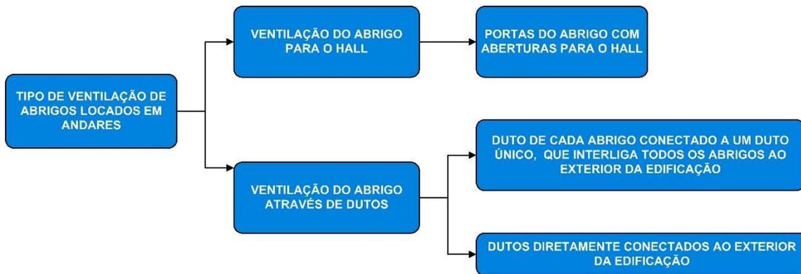
Figura 4-j. Possibilidades de ventilação do abrigo locado em andar
